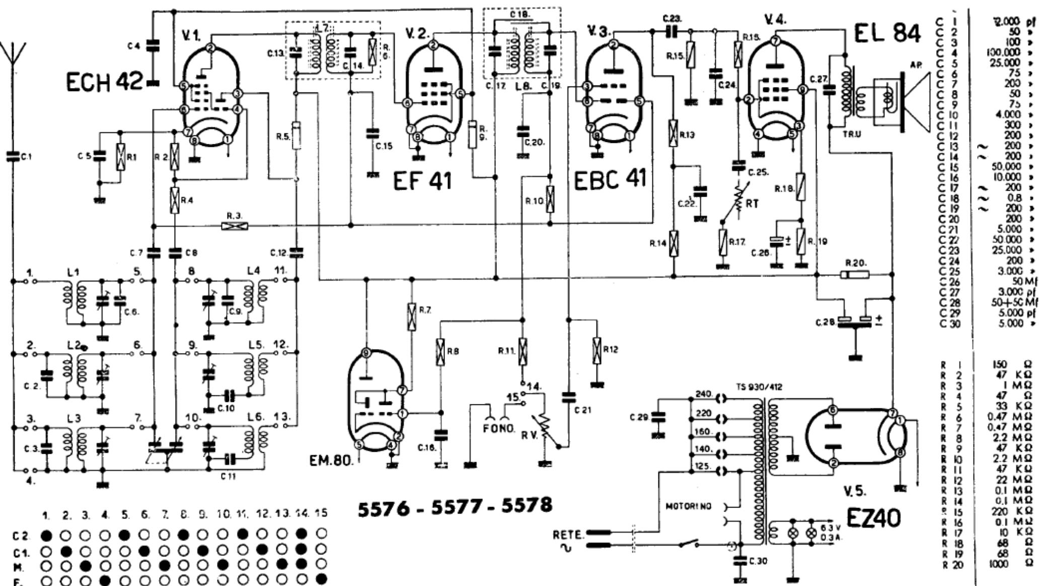
FIMI S. A. - PHONOLA - Modd. 5576, 5577 e 5578. Una gamma onde medie da 183 a 575 metri. Onde corte da 27,3 a 80 metri e da 15,8 a 28 metri. Media frequenza 470 kc/s. Consumo 50 watt. Potenza indistorta 5 watt. Montaggio della cordina come per il mod. 5532 F.
